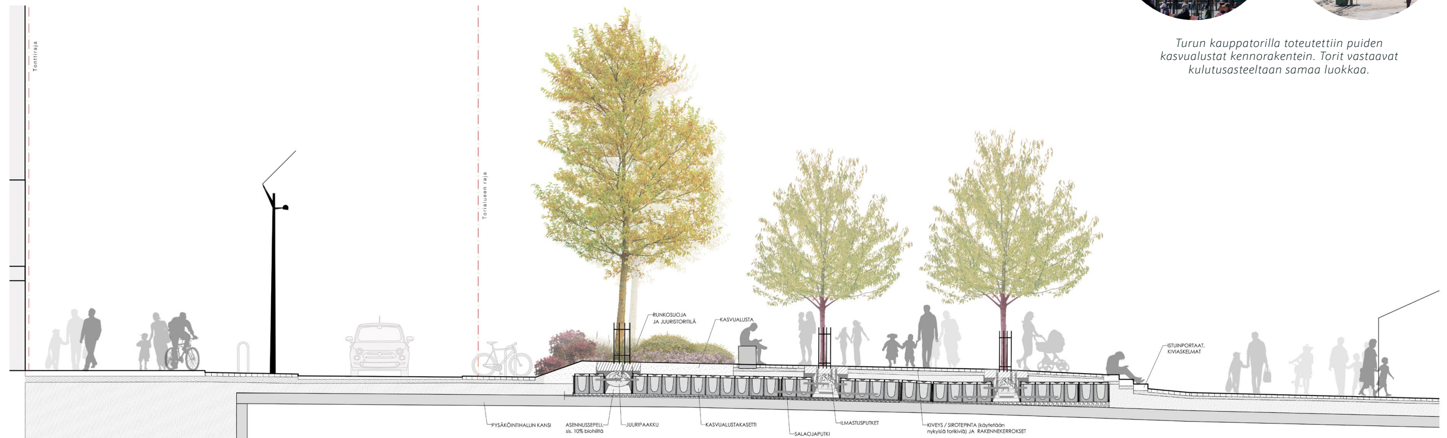
Periaateleikkaus, ei mittakaavassa. Korotetut reunat mahdollistavat yhtenäiset, riittävät kasvualustat
